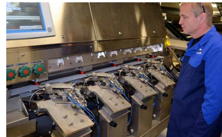
Tvæir koppsetingarmaskinur hava avloyst eini 12–14 fólk. Eini 18.000 smolt verða koppsett um tíman við báðum koppsetingarmaskinunum á støðini
