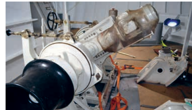
Akkersspælið og onnur størri tól, vórðu sett umborð fyri at sleppa undan at gera nýggj hol í skrokkin
