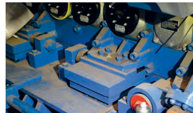
Motorurin stendur á sonevndum dupluttum pútum fyri, at larmurin ikki skal breiða seg út í sjógvín
