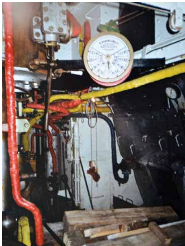
Partur av maskinrúminum á S/S Björn. Ovast á myndini síggja vit regulatorin. Mynd: Klæmint Jacobsen
